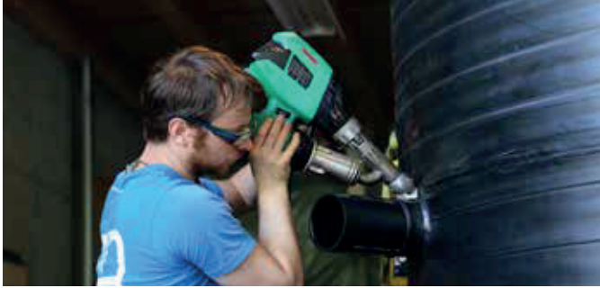
La manejable WELDPLAST S2 en acción.
