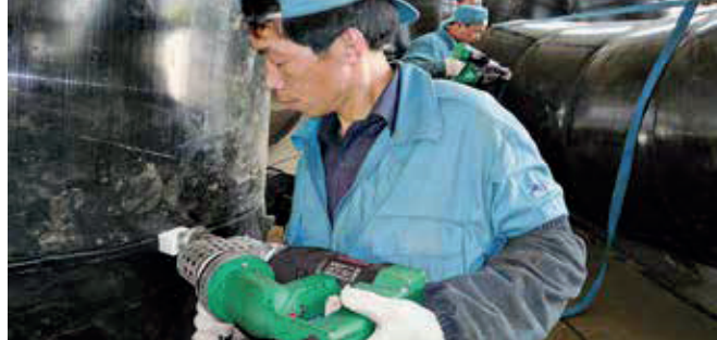
La FUSION 2 en la construcción de recipientes.
