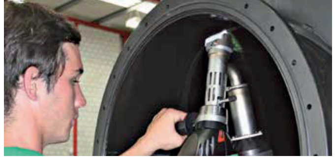
Simple auto-soldadura de radios interno.
