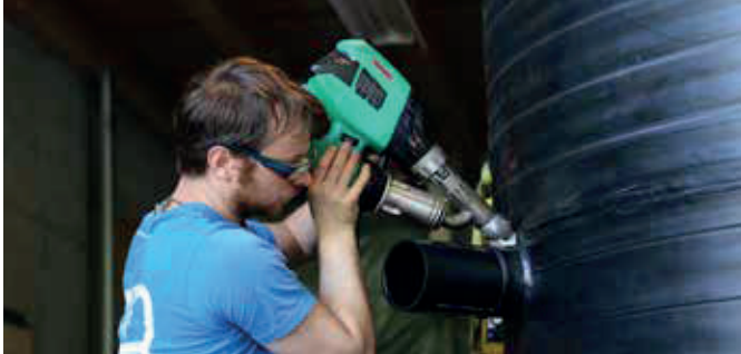
La manejable WELDPLAST S2 en acción.
