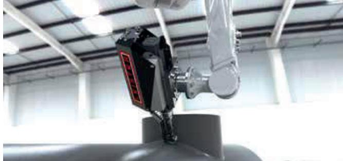
WELDPLAST 200-i y 600-i: soldadura por extrusión automatizada e impresión en 3D diseñadas para un funcionamiento continuo automático.
