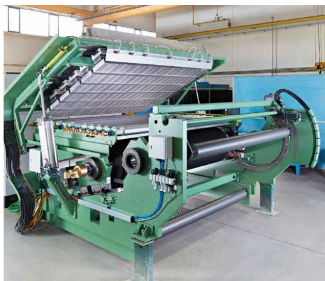
Precalentamiento con infrarrojos KRELUS para máquinas de grabado en relieve. Fuente: Kampf LSF GmbH, Laussig, Alemania
