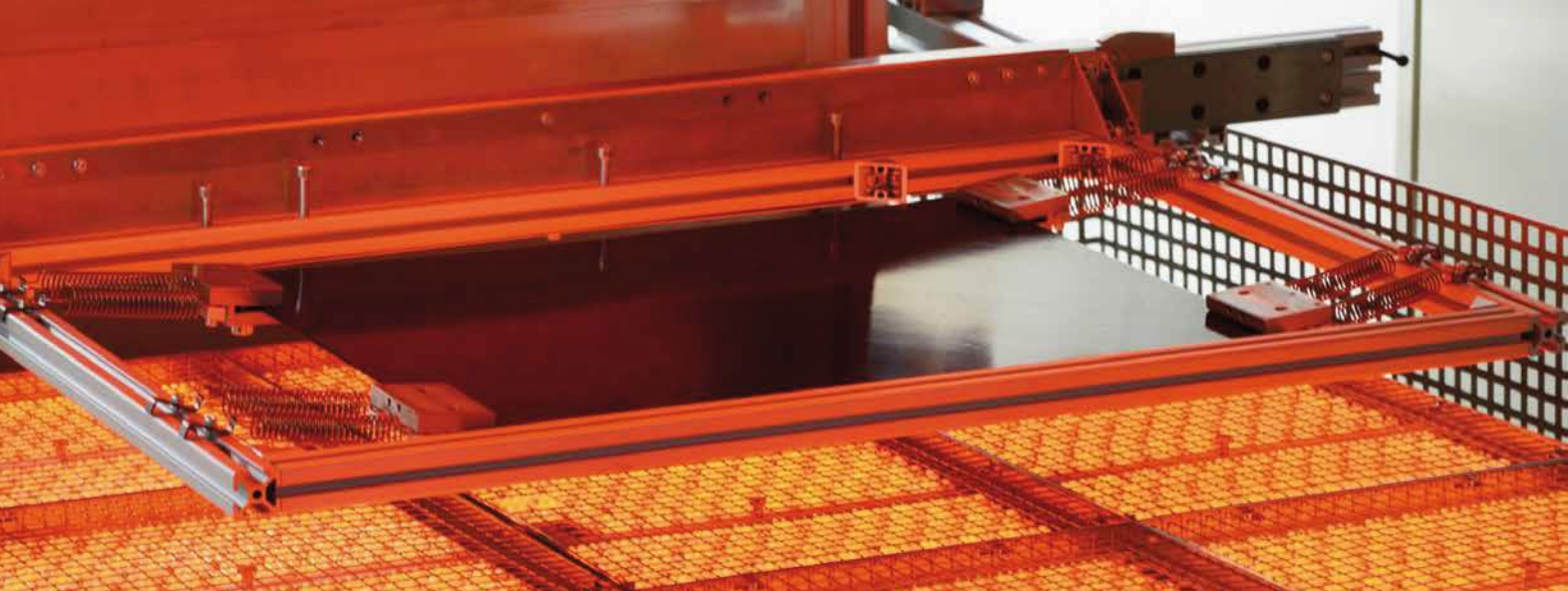
Calentamiento homogéneo de una lámina Organo Fuente: Fraunhofer IPT
