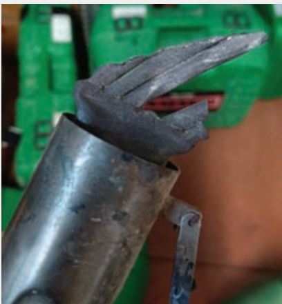
Falta de mantenimiento
