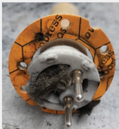
Filtro no instalado
