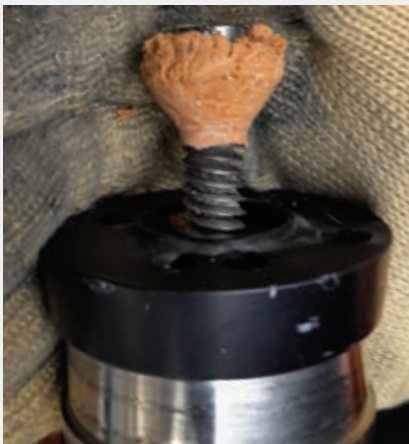
Manipulación incorrecta: Se introdujeron dos hilos de soldadura juntos, lo que provocó que el plástico retrocediera.
