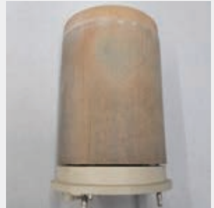
Desgaste del elemento calefactor
