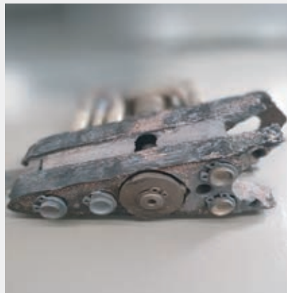
Cuña caliente con fuerte desgaste
