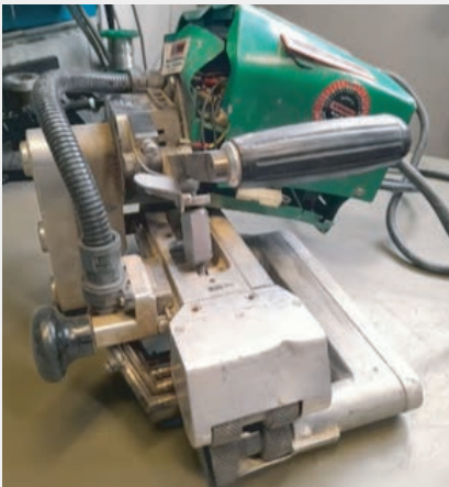
Choque, daño mecánico
