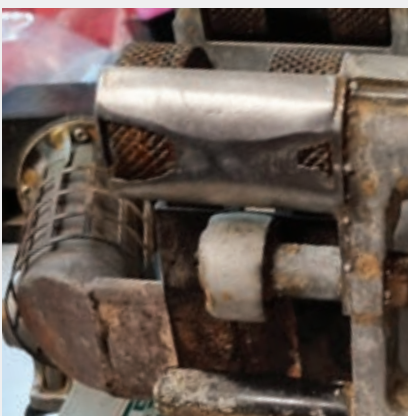
Placa de protección defectuosa debido a un desgaste intenso
