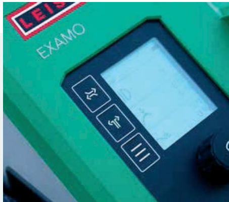
Botones directos para ensayos de cizallamiento y pelado
