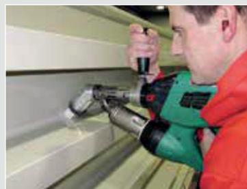
Facilita la soldadura en posiciones difíciles: la tobera angulada de 45° de WELDPLAST S2. (accesorio)
