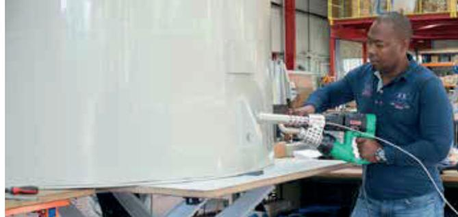
FUSION 3C al soldar una soldadura en ángulo.
