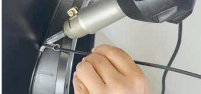
Boquilla de soldadura rápida
