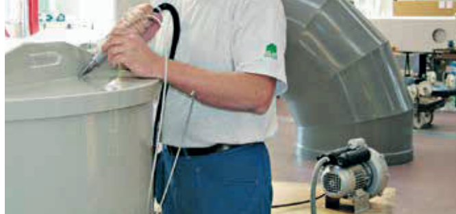
Soplante ROBUST como suministro de aire para el WELDING PEN.
