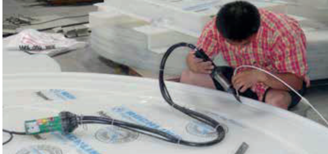
Soplante MINOR como suministro de aire para la DIODE PID.
