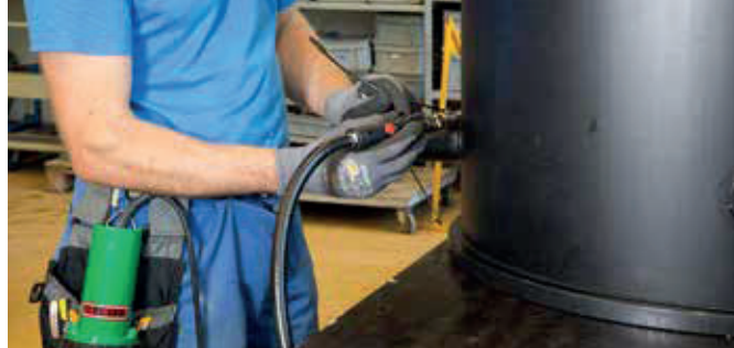
LABOR S acoplada con el MINOR como suministro de aire externo.
