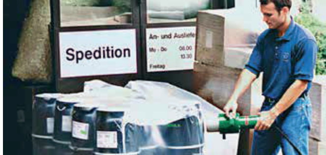
Retracción sin llama de palés y mercancías voluminosas en recintos cerrados.
